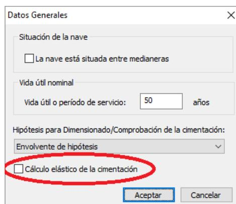
Activando esta opción, se realiza un cálculo elástico sobre la nave y su cimentación, de tal forma que se permite un cierto giro en la base de la misma. De este modo se reduce en muchos casos significativamente las dimensiones de la cimentación ya que parte del momento que llega a las zapatas es compensado por el par de fuerzas que se generan entre la base de cimentación y el dintel de la nave. Este giro se controla por la condición de deformación admisible en cabeza de pilares.
